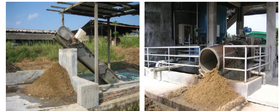
Gambar 2: Contoh kaedah untuk pengasingan sisa pepejal dan cecair
