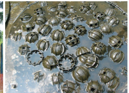
Gambar 7: Contoh sistem Bio-filter menggunakan bola media
